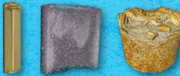
◀ Illustrations d'échantillons analysés par micro tomographie : de gauche à droite une batterie lithium-ion, une roche subissant une injection de CO 2 et un clathrate utilisé dans le captage de CO 2
