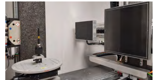
▲ Micro-tomographe à rayons X (Tescan UniTOM XL Spectral) restitue la forme et la composition des objets grâce à ses deux détecteurs
