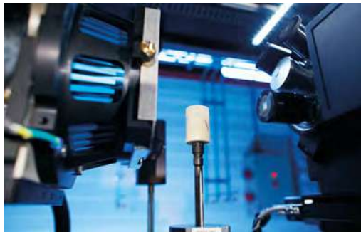
▲ Micro-tomographe à rayons X (Zeiss Xradia Versa 510) permet d'atteindre des résolutions sub-microniques par grandissement optique
